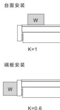
图3 负载安装系数: K
